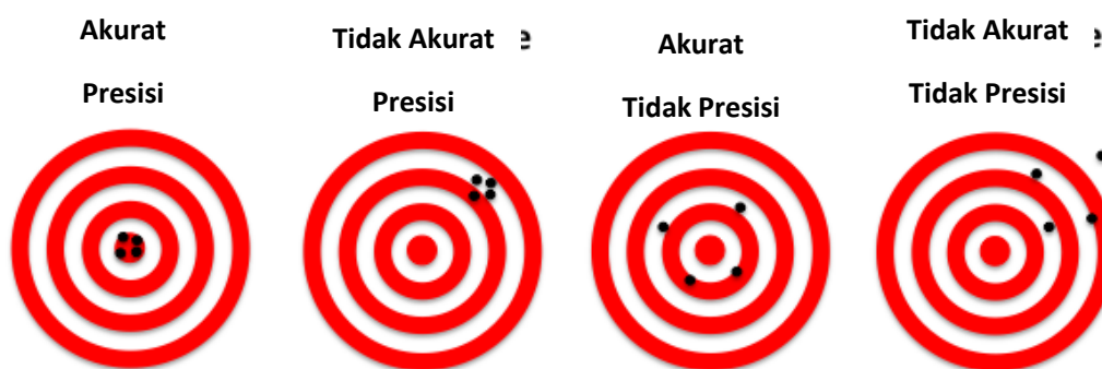
Gambar 2.1 Presisi dan akurasi diilustrasikan melalui sebuah target ( http://www.dnasoftware.com/wp-content/uploads/2015/07/targets.png )
